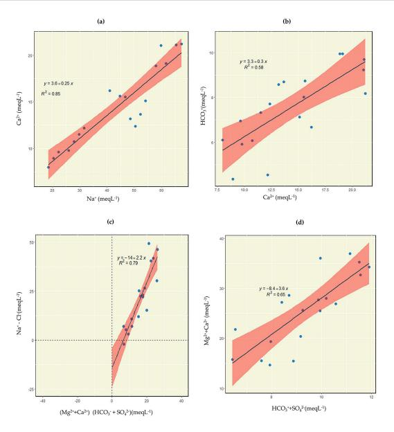
**Figure 4.** Illustration of effects of mineralogy and geochemistry on groundwater hydrogeochemical characterization (a) Na<sup>+</sup> vs. Ca<sup>2+</sup>; (b) Ca<sup>2+</sup> vs. HCO<sub>3</sub><sup>-</sup>; (c) (Ca<sup>2+</sup> + Mg<sup>2+</sup>)-(HCO<sub>3</sub><sup>-</sup> + SO<sub>4</sub><sup>2-</sup>) vs. Na<sup>+</sup> - Cl<sup>-</sup>; (d) (Ca<sup>2+</sup> + Mg<sup>2+</sup>) vs. (HCO<sup>3-</sup> + (SO<sub>4</sub><sup>2-</sup>)
